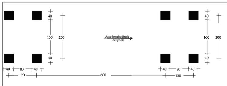
Fig. 5.1.5 - Modello di carico di fatica. 3
