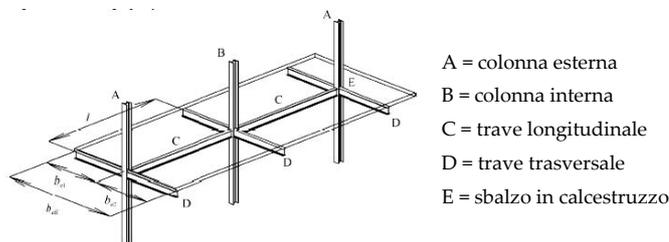
Fig. 7.6.2 - Definizione degli elementi in una struttura intelaiata
