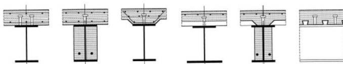
Fig. 4.3.3 - Tipologie di sezione composte per travi
