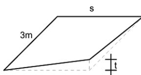
Fig. 5.2.14 - Sghembo ammissibile
