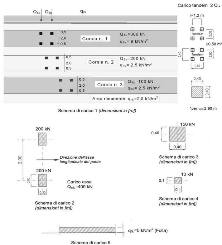
Fig. 5.1.2 - Schemi di carico 1 – 5 (dimensioni in m)
