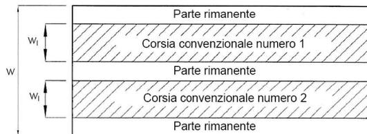
Fig. 5.1.1 - Esempio di numerazione delle corsie
